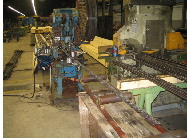
Lohnstanzen (Profile für Eisenbahnwaggons) für Böhler Profil Arbeitete zwei Wochen im Schichtbetrieb
